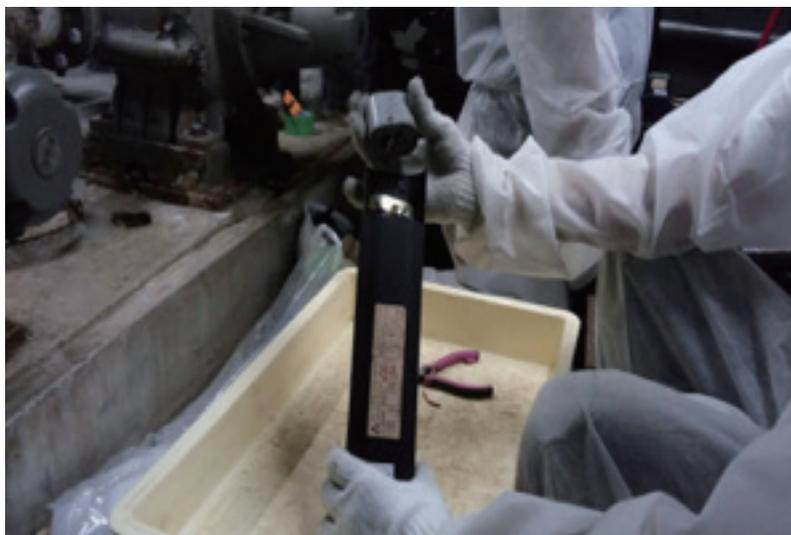
左のようにPCB入りコンデンサが充填剤によって固定されていない外付け型安定器は、コンデンサのみを取り外すことによって、その重量を軽くすることができます。処分金額を大幅に削減することができます。（重量が約10分の1くらいになります）。また取り外しをした残部材（鉄等）は濃度分析し、その結果、低濃度として処分することが可能です。
